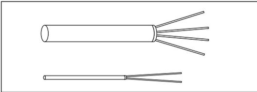
세라믹을 사용한 백금 축온저항체 소자는  $-200^{\circ}\text{C} \sim 600^{\circ}\text{C}$ 의 온도 측정에 사용됩니다. 백금 코일은 순도가 높은 산화 알루미늄으로 채워진 모세관 안에 세라믹 프리트(유리원료)에 설치되어 있습니다.
