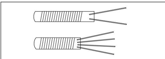
백금 축온저항체 소자는  $600^{\circ}\text{C}$ 에서도 견딜 수 있도록 일체형으로 된 유리 안에 설치되어 있습니다. 강한 유리 캡슐에 장착된 축온저항체 소자는 백금선 자체가 밀봉되어 있어 액체 안에서도 직접 온도를 측정할 수 있습니다.
